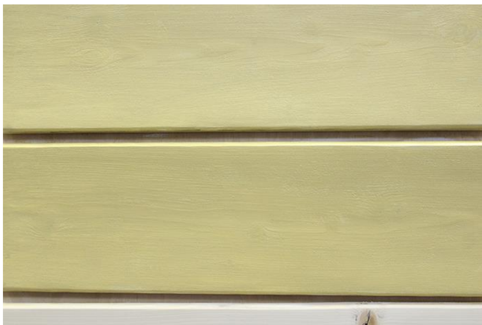
Готовое покрытие Pullex Color (2-х слойное нанесение)
