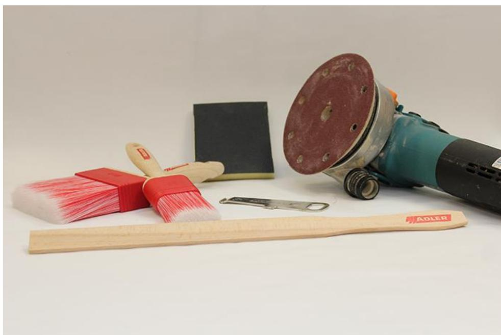
**Подготовка основания: для внутренней отделки финишное шлифование шлиф.шкуркой с зерном 120мкм вдоль волокон. Обратить внимание, чтобы шкурка была предназначена для шлифования древесины.**
