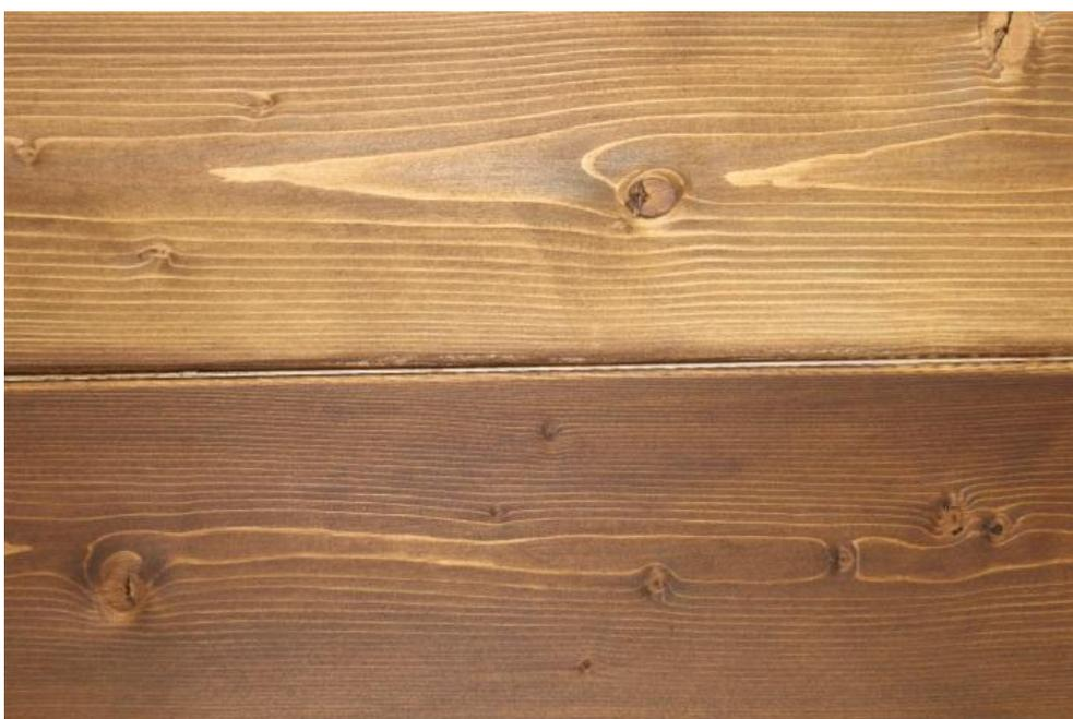
образцы с однослойным и двухслойным нанесением
