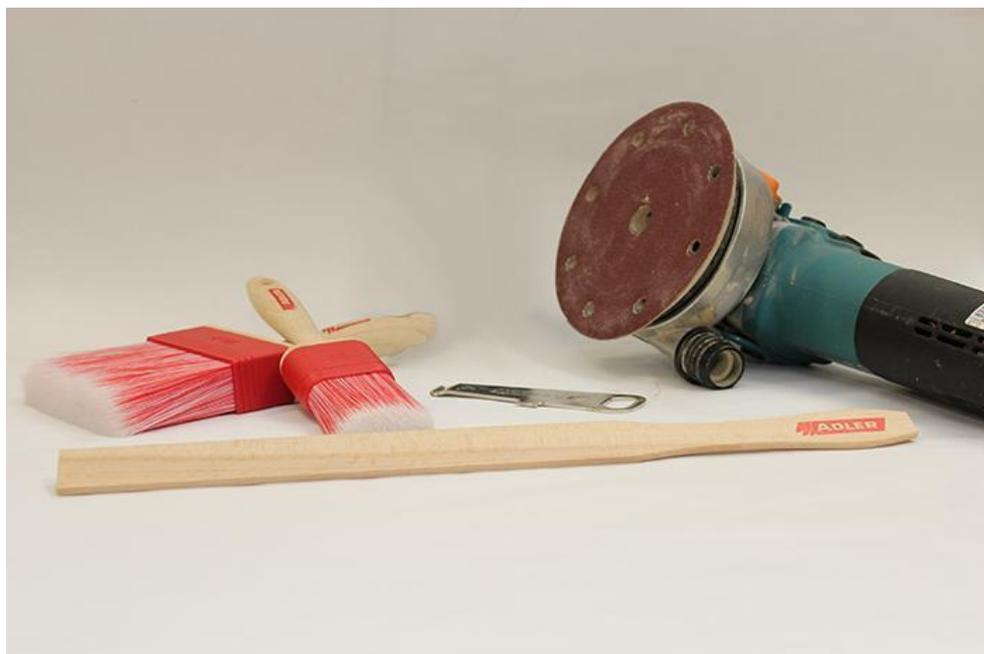
**Подготовка основания:** для наружной отделки финишное шлифование шлиф. шкуркой с зерном 80мкм (или 60мкм, чем грубее, тем эффектнее будет финишное покрытие) вдоль волокон. Обращать внимание, чтобы шкурка была предназначена для шлифования древесины.
